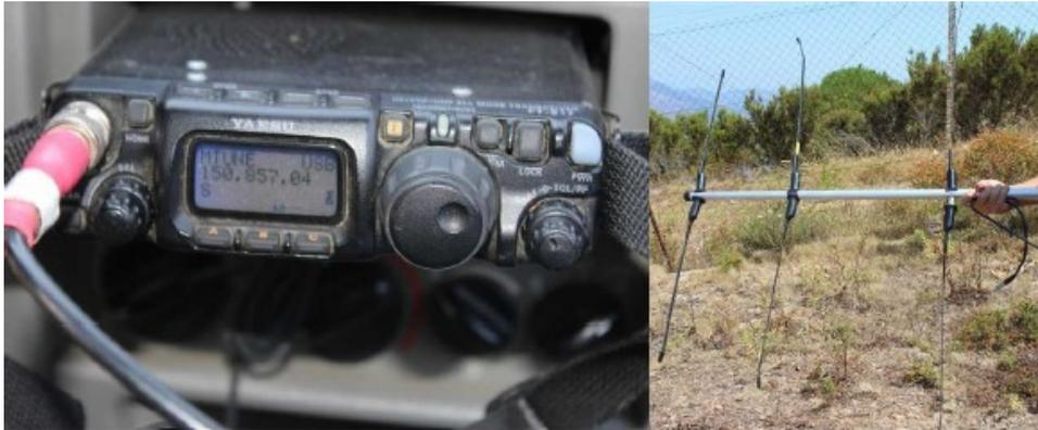
Figura 32: Ricevente Yaesu FT-187 e antenna Yagi a tre elementi
